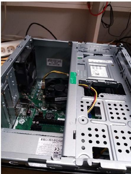
Et pour terminer, on remplace le disque dur par le SSD et on démarre le PC pour voir si le clonage a fonctionné car il peut arriver que le disque dur soit trop vieux pour être cloné.
