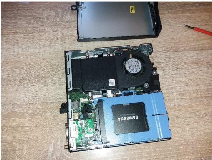
On remet le ventilateur à sa place et on ajoute le SSD Samsung à l'endroit prévu et on remonte la plaque en métal.
