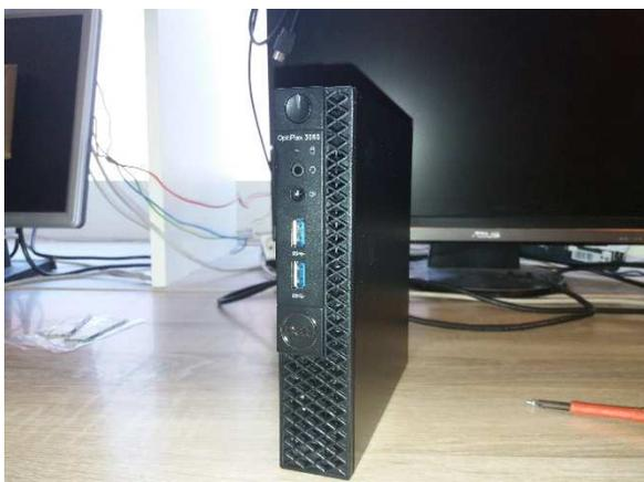
Un pc DELL Optiplex 3060 disposant d'un processeur Intel core i5, d'un M2 SSD de 120GB et d'une barrette de rame de 4GO.
